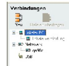
Um eine Verbindung zu einem anderen Computer herzustellen, müssen Sie zuerst eine neue Verbindung erstellen. Stellen Sie sicher, dass PCsync auf dem Hostcomputer ausgeführt wird (dem Computer, zu dem Sie eine Verbindung herstellen möchten). Wenn Sie das USB-Kabel verwenden möchten, stecken Sie es jetzt in die USB-Anschlüsse der beiden Computer. Klicken Sie nach Abschluss dieses Vorgangs auf die Schaltfläche Neue Verbindung.
